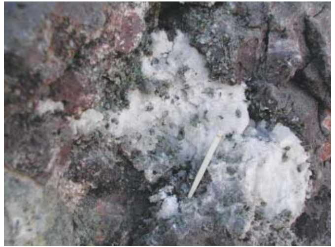
Figura 12. Cristales de piroxeno, apatita, cuarzo y calcita en la brecha del Cuerpo Oriente.
